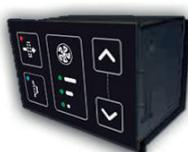
**Easy 3E** - Dispositivo da incasso su scatola 503 orizzontale. Gestisce le funzionalità di: on/off unità, scelta della portata di rinnovo fra le 3 preparate, protezione antigelo, rilevamento filtri sporchi e anomalia sonde temperatura. Alimentazione + comunicazione: cavo in dotazione 3 m (allungabile fino a 30m UTP cat. 5 o 5E).
